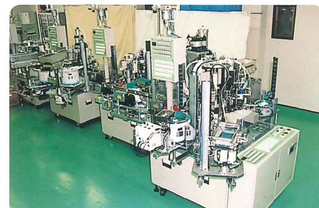
エア機器組立 サイクルタイム1.3~1.5秒 BM-500 1台とBM-300 3台連結
