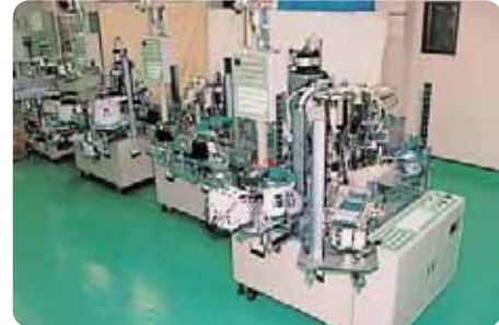
エアージェット組立 サイクルタイム1.3~1.5秒 BM-500 1台とBM-300 3台連結
