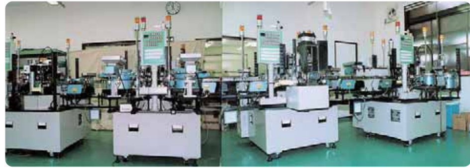
電気部品組立 サイクルタイム1.7秒 BM-300を4台連結
