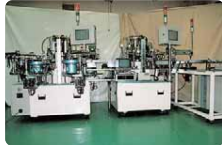
電気部品組立 サイクルタイム2秒 BM-500を2台連結
