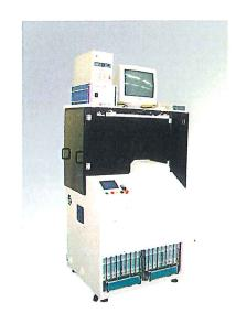
チップ型LEDをパーツフィーダーより供給し、ターンテーブル上で、電気特性検査、光度検査、色調検査を行い、検査結果に基づきランク分けされたワークを排出ポットに排出する分類機。ポットを引出式にすることで作業性を向上。
